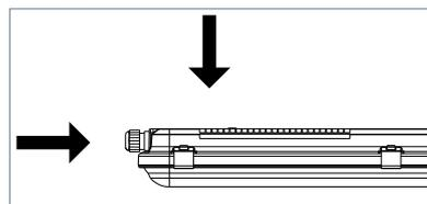
Cablage traversant possible par le dessus
