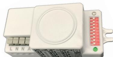
**DÉTECTEUR DE MOUVEMENT** qui émet des ondes électromagnétiques à haute fréquence (5,8 GHz) et reçoit leur écho. En l'analysant, il peut reconnaître toute variation donnée par un objet non détecté dans l'analyse précédente. À ce stade, un microprocesseur de la commande ON.
