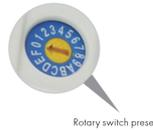
Le commutateur rotatif est construit à l'intérieur du capteur pour la sélection du scénario / programmation rapide. Au total, 16 canaux sont disponibles :
